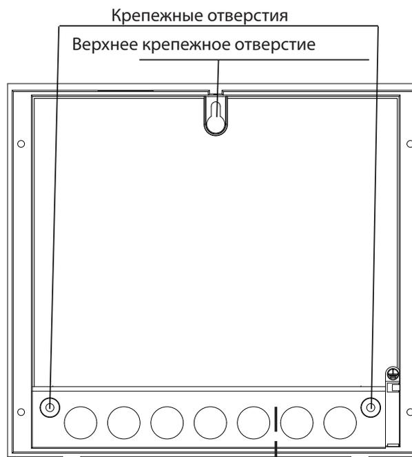
Отверстия для следующих проводов: Сетевая подводка; подводный провод печи; подводный провод испарителя; лампа; вентилятор
